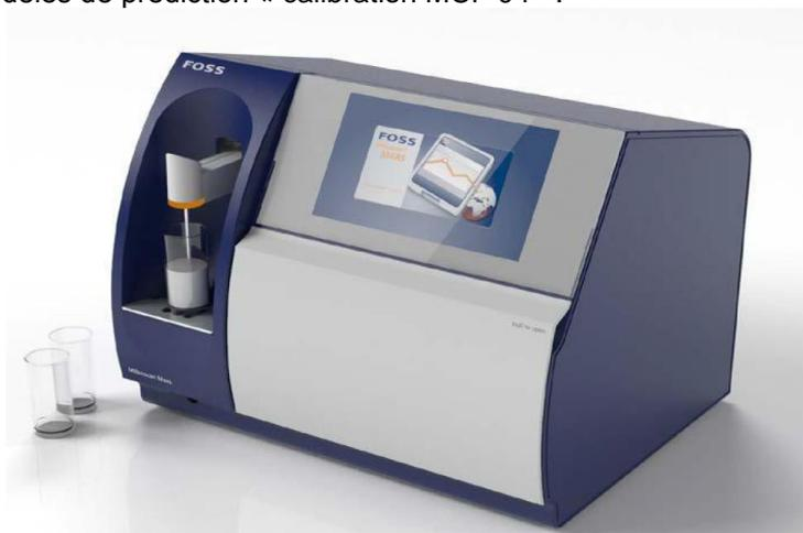
L'appareil a été installé dans une pièce à température contrôlée (20-23 °C – climatisation), sans lumière directe du soleil. La procédure d'installation a été effectuée par Foss.
