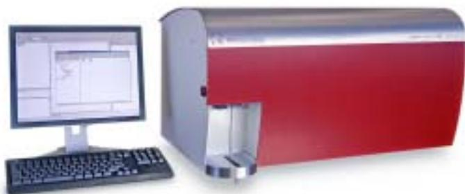
Le Lactoscope FTIR™, fabriqué par la société Delta Instruments (Pays-Bas, groupe Advanced) et commercialisé en France par la société Laboratoires Humeau, est un spectrophotomètre moyen infra-rouge qui permet la détermination des paramètres de composition majeurs (matière grasse, matière protéique, matière sèche, point de congélation et matière azotée totale) du lait, de la crème et du fromage.
